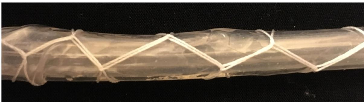
Рис. 2. Схема плетения фиксирующей нити
