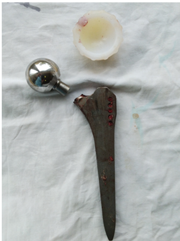
Рис. 2. Вид удаленного бедренного компонента эндопротеза
